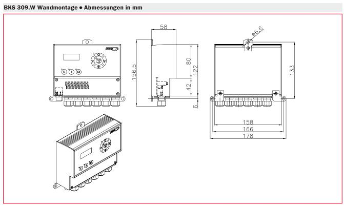
Verdrahtung über Kabeldurchführungen mit Schutzklasse IP 65.
