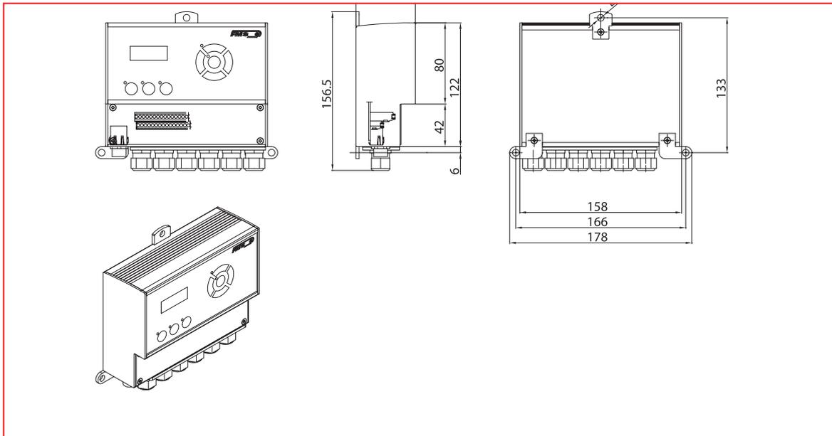
Verdrahtung über PG-Kabelverschraubungen. Schutzklasse IP 65.
