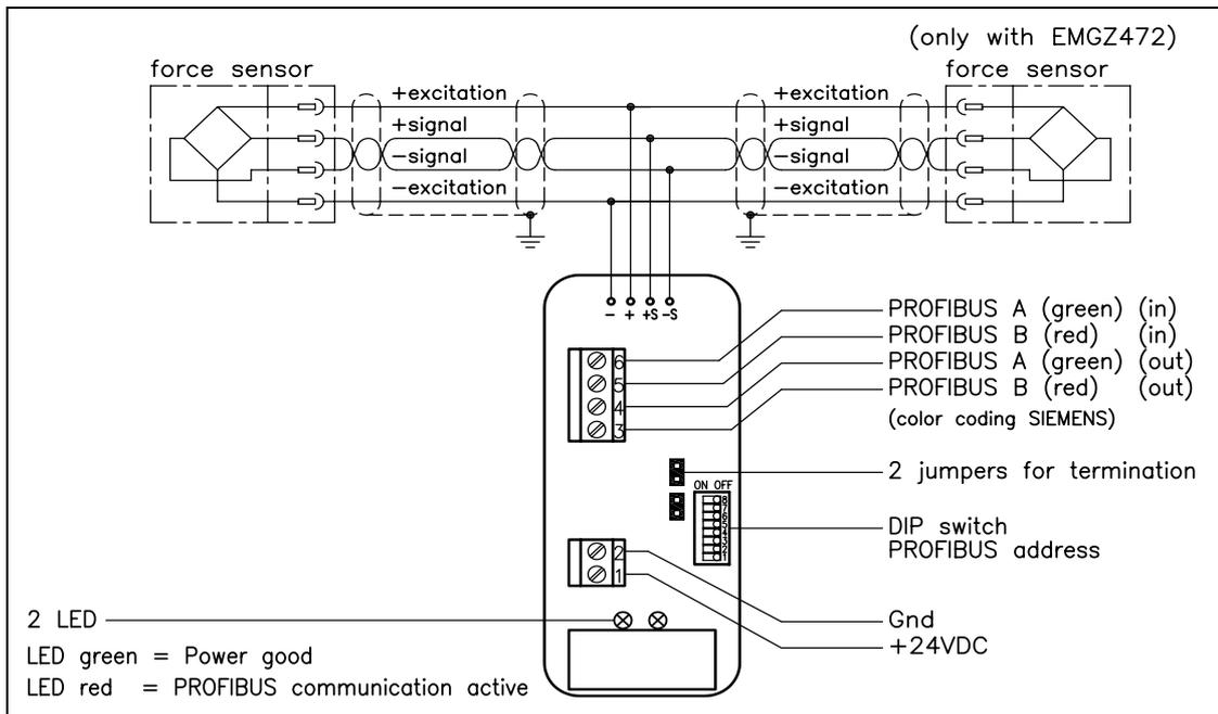
**fig. 8: Wiring diagram EMGZ470A.W/472A.W**
