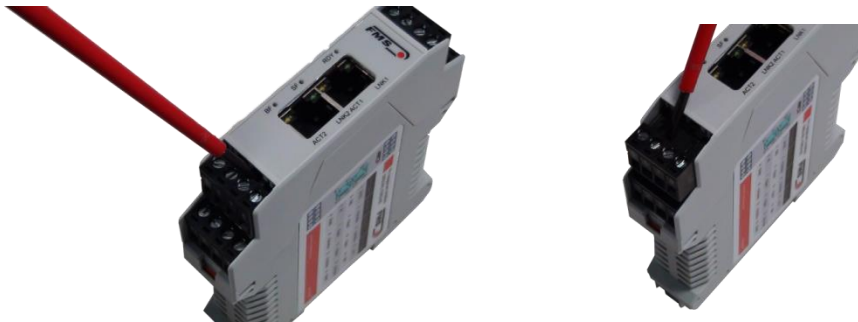
Abbildung 3: Lösen der Klemmenblöcke: Vorsichtiges Aushebeln mit kleinem Schraubendreher
