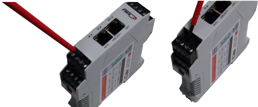
Abbildung 3: Lösen der Klemmenblöcke: Vorsichtiges Aushebeln mit kleinem Schraubendreher
