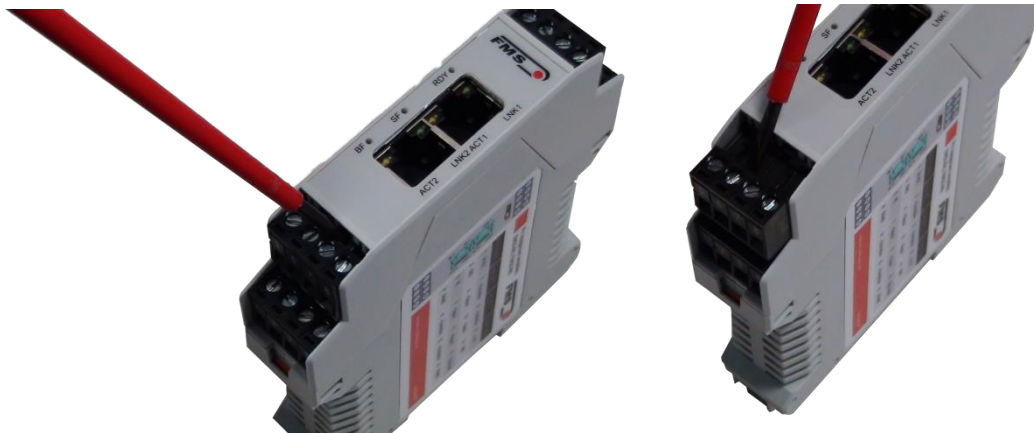
Abbildung 3: Lösen der Klemmenblöcke: Vorsichtiges Aushebeln mit kleinem Schraubendreher
