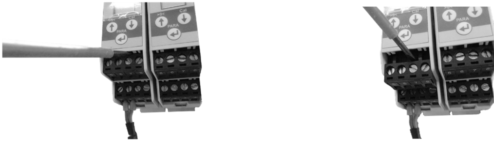
Abbildung 3: Lösen der Klemmenblöcke: Vorsichtiges Aushebeln mit kleinem Schraubendreher
