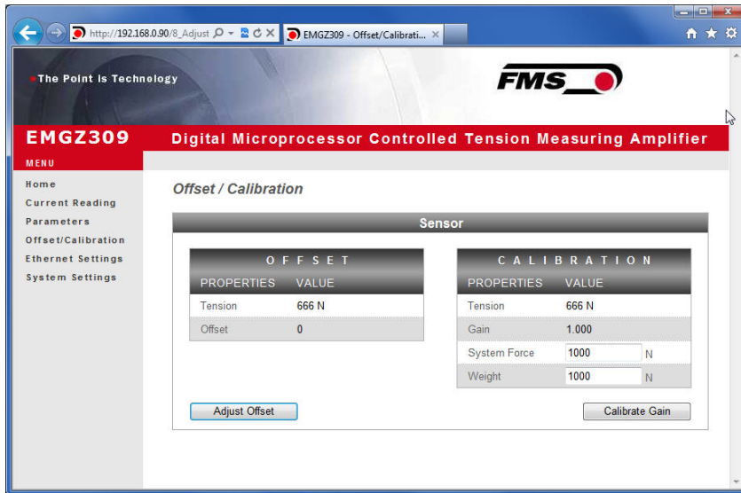
Bild 29: Offsetkompensation und Kalibrierung Gerätemodus Anzeige-Kraftmessung Offset-Calibration-Force
